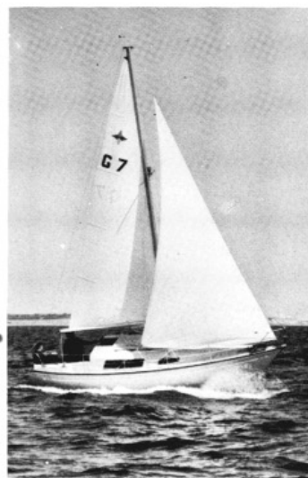
Sirius 26: Gutes Segelvermögen durch hohen Ballastanteil und breiten Rumpf
