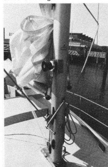
Reichel-Mast mit Fallwischen und „Volksreffer“. Die Reifeinrichtung funktionierte ohne Störungen
